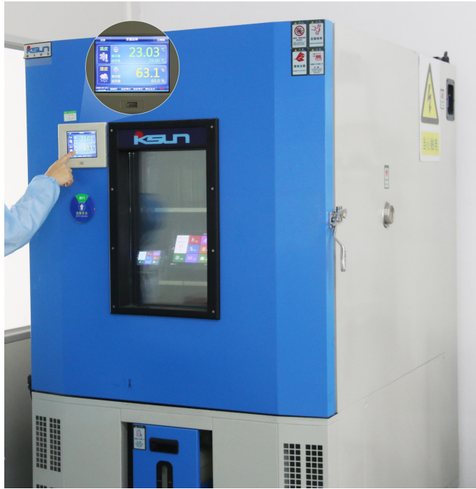
图 5-3 高低温老化测试图
